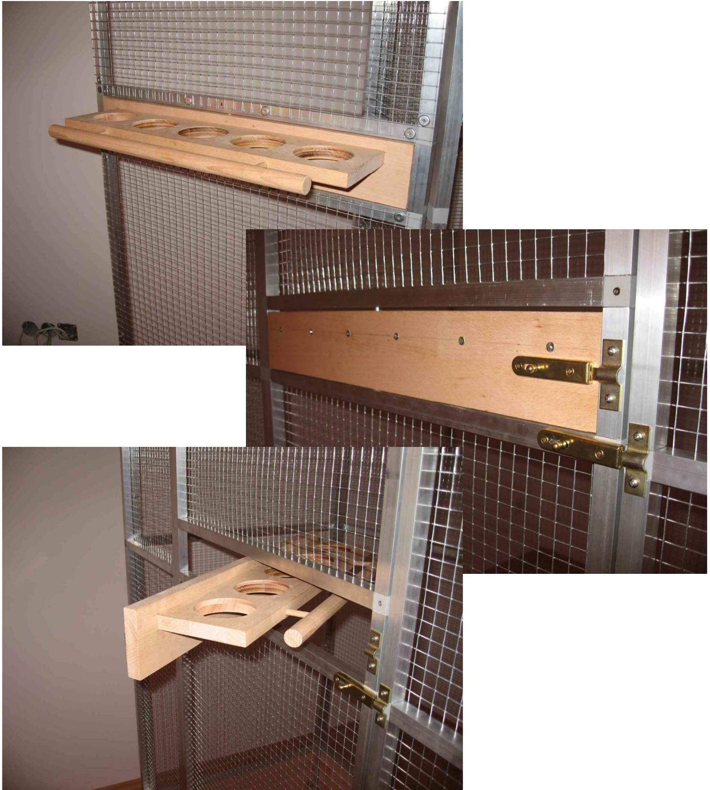
Die Sitzstange die an der Drehplatte angebracht wurde, haben wir einfach mit Hilfe von 8mm Holzstangen Befestigt. Wir haben Löcher in die Halteplatte und in die Sitzstange gebohrt, wo dann die 8mm Stange rein gesteckt und verklebt wurde.
