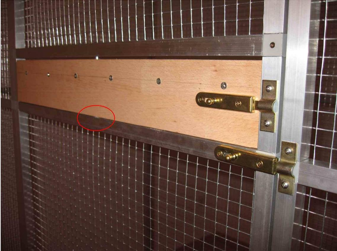
Nun kann das Türober- und unterteil mit der Holzplatte dazwischen auch zusammen geklopft werden. Beim vergittern der einzelnen Elemente ist es sinnvoll, beim Dach und den Seitenteilen den Draht an allen Seiten überstehen zu lassen. So kann man ihn einfach nach außen umbiegen und es kann sich beim Klettern kein Vogel verletzen.
