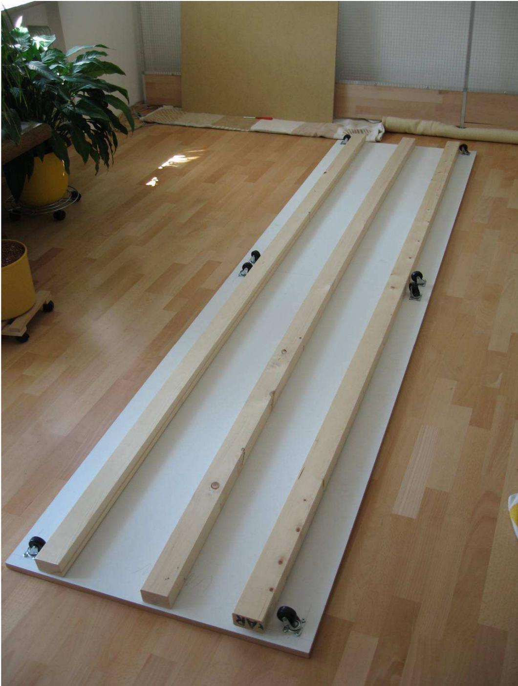
Die Trägerbalken sind mit der Grundplatte verschraubt. Wir haben die Schrauben durch die Spanplatte in die Trägerbalken geschraubt, weil die Schrauben in Holz besser halten als in Pressspanplatten. Man sieht zwar dann die Schraubenköpfe in der Bodenplatte, aber wenn später die Kotschubladen eingeschoben werden ist das nicht weiter störend.
